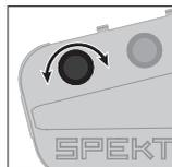
Faites tourner le potentiomètre ST RATE dans le sens anti-horaire pour réduire la sensibilité.
