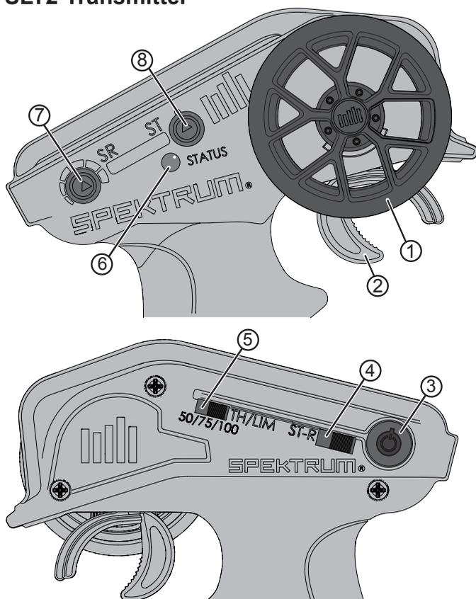
1. **Steuerrad** Steuerung (links/rechts) des Modells
