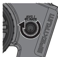
Faites tourner le potentiomètre ST RATE dans le sens horaire pour augmenter la sensibilité.
