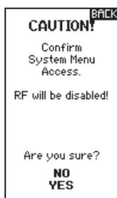
Premere e tenere premuto il pulsante scorrevole mentre si accende la trasmittente per mostrare l'elenco delle Configurazioni di sistema. Mentre viene mostrata la schermata System Setup, il segnale radio è interrotto, per evitare danni accidentali ai collegamenti e ai servo durante le modifiche della programmazione.
