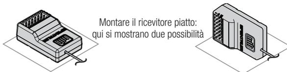
È possibile montare il ricevitore su uno dei sei lati senza dare importanza alla direzione verso la quale punta il ricevitore. Il ricevitore non deve essere perpendicolare al veicolo, a condizione però che sia piatto e in piano.
