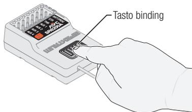
**IMPORTANTE:** È necessario tarare il ricevitore SR6200A ogni volta che viene messo in modalità binding, a prescindere dal fatto che AVC sia attivata o disattivata.
