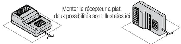
**IMPORTANT :** Ne pas utiliser la bande velcro pour installer le récepteur SR6200A. Utiliser une bande velcro aura un effet sur les performances du système AVC.
