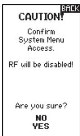
Betätigen und halten Sie die Schiebepaste während der Sender eingeschaltet wird, um die Systemkonfigurationsliste anzuzeigen. Es treten keine Funkübertragungen auf, wenn ein „System Setup“-(Systemkonfiguration-)Bildschirm angezeigt wird, um unbeabsichtigte Schäden an den Gestängen und Servos während der Änderungen an der Programmierung zu vermeiden.
