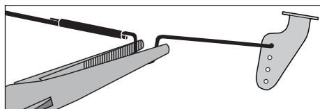
**Per ottenere le migliori prestazioni con AS3X, è importante non utilizzare un trim eccessivo.** Se il velivolo richiede un trim del trasmettitore eccessivo (4 o più clic di trim per canale), riportare il trim del trasmettitore a zero e regolare meccanicamente i collegamenti in modo che le superfici di controllo siano nella posizione di volo trimmata.
