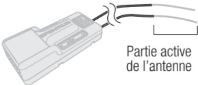
**REMARQUE :** Ne pas couper, tordre ou modifier les antennes. Toute détérioration de la partie coaxiale d'une antenne en réduira les performances. Le raccourcissement ou le sectionnement de l'embout de 31 mm réduira la portée.
