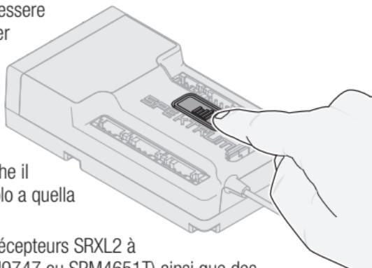
1. Branchez jusqu'à deux récepteurs SRXL2 à distance facultatifs (SPM9747 ou SPM4651T) ainsi que des capteurs de télémesure au récepteur principal.
