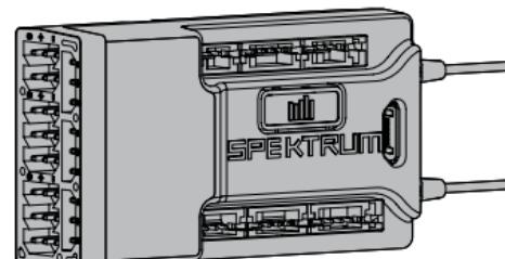
Sie können den AR10360T-Empfänger über einen kompatiblen Spektrum-Sender mit Vorrätsprogrammierung einrichten. Der Spektrum PC Programmer kann für die Firmware-Aktualisierungen verwendet werden.
