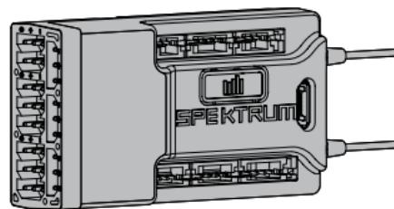
**IMPORTANT :** Le récepteur AR10360T n'utilise la programmation en aval que pour la configuration ; n'utilisez pas le menu AS3X dans le menu principal de l'émetteur.
